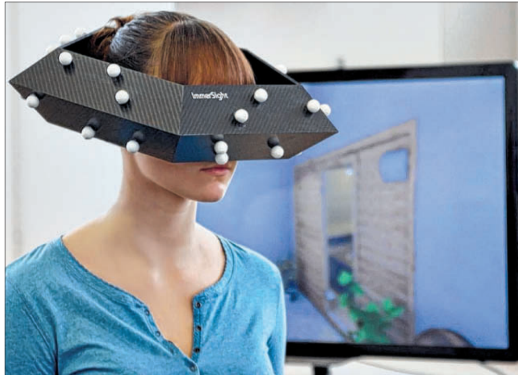
So sieht die Raumbrille aus: Von außen ein schwarzes Fünfeck, innen ist eine Videobrille. Die Anordnung der weißen Kugeln ist auf jeder Seite anders, damit der Computer erkennt, in welche Richtung der Träger schaut. Rechts die vier Erfinder: (von links) Simon Sagler, Fabian Weiss, Dominik Nuss und Stefan Hörmann. Fotos: Privat/Oliver Schulz
